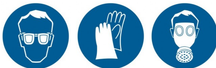
Rysunek 4: Znaki nakazu najczęściej pojawiające się w karcie charakterystyki kleju (od lewej): nakaz stosowania ochrony oczu, nakaz stosowania ochrony rąk, nakaz stosowania ochron dróg oddechowych
